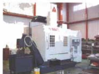
油機工業 立旋盤 YV-1600ATC
